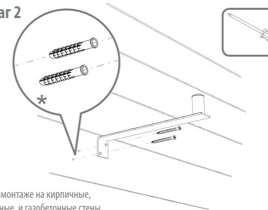
\* При монтаже на кирпичные, бетонные, газобетонные стены
