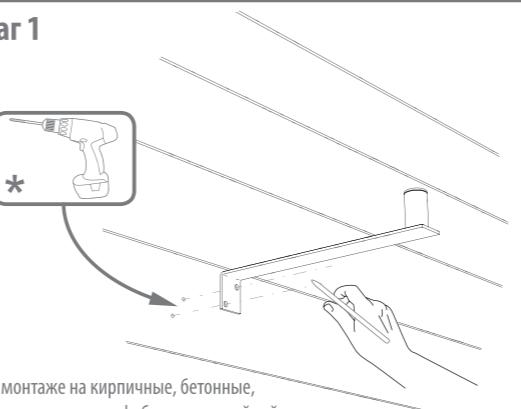
\* При монтаже на кирпичные, бетонные, газобетонные стены и фиброкерамический сайдинг
