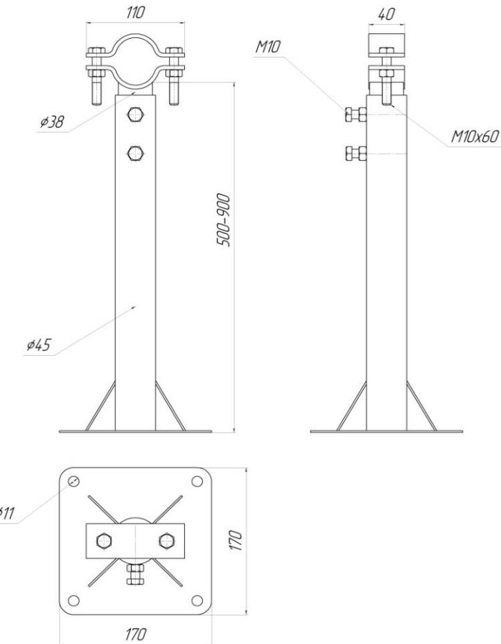
ВНИМАНИЕ! ПЕРЕД УСТАНОВКОЙ УБЕДИТЕСЬ, ЧТО КРЕПЛЕНИЕ И ПОВЕРХНОСТЬ, НА КОТОРУЮ УСТАНАВЛИВАЕТСЯ КРОНШТЕЙН ВЫДЕРЖАТ ВЕС КРОНШТЕЙНА С ОБОРУДОВАНИЕМ УСТАНОВЛЕННЫМ НА НЕГО
